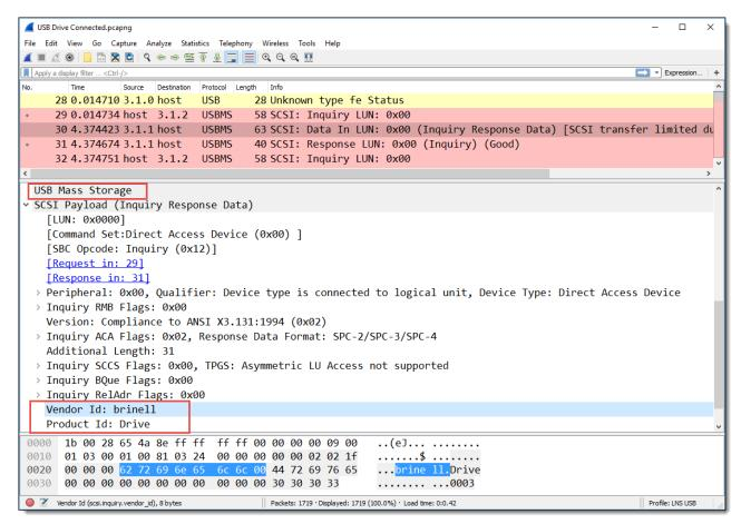
Bild 14: Aufzeichnung des Verbindungsaufbaus zu einem USB Harddrive
