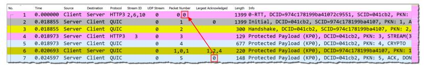
Frame 7: Server schickt TLS Handshake Done und bestätigt Paket 0 (Packet Type 0-RTT)
