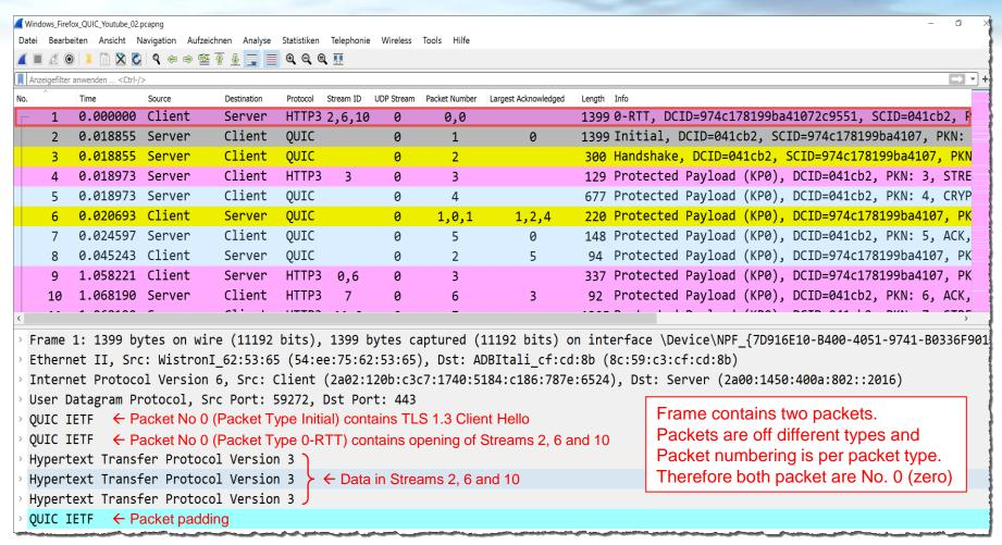
Frame 1: Client startet 0-RTT Verbindung, enthält TLS Client Hello, öffnet 3 Streams und sendet HTTP/3 Daten
